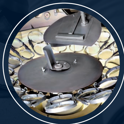
CAMERA AD ALTO VUOTO PER REALIZZARE RIVESTIMENTI ANTIRIFLESSO
